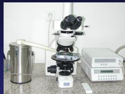
Masuta de încălzire/răcire pentru micro-termometrie Linkam THMSG600 cu control automat al temperaturii
