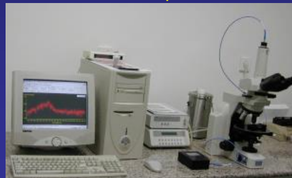
Microspectrometru de mare rezoluție HR2000 pentru UV/VIS (400-800nm, 50-8 μm suprafața de citire, 2 nm rezoluție)
