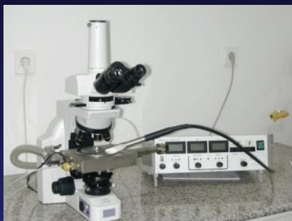
Dispozitiv de catodoluminescență CL 8200 MK3 (CITL) pentru microscop Nikon cu lumină polarizată
